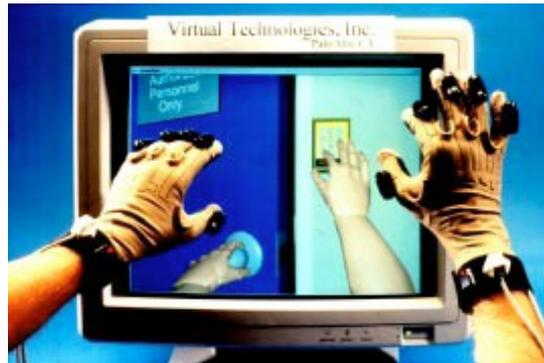
**Ilustración 2-2 Ejemplo de uso de un CyberTouch**
